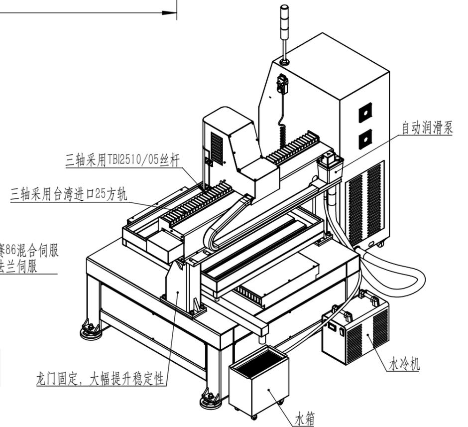
本机为MKD-1080-M精雕机, 行程X 1米, Y轴0.8米, 适用于铁板 (HRC30以下), 铜铝板, 工程板精雕
